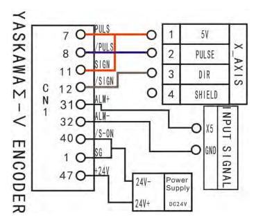
Motor Brake: YASKAWA  $\Sigma$ - V( $\Sigma$ -7 same as  $\Sigma$ -V),Set Pn50F=0300
